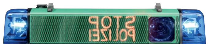
mit Xenon-Rinnenparabolsystem, integriertem Anhalte-signalgeber ASG und Blitzscheinwerfer BSX-F
